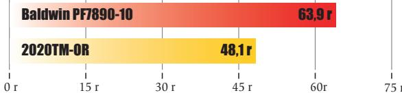
Испытание методом SAE J905: расход 681,4 л/ч, контрольная тонкодисперсная пыль компании РГП, скорость накопления пыли 12 г/6 г, конечный перепад давления 68,9 кПа. Средневзвешенная во времени эффективность.
