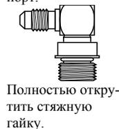
**2** Вкрутить фитинг с уплотнительным кольцом до контакта шайбы с портом. Затягивать только вручную.
