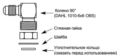
**Примечание:** сначала смонтировать устройство, затем установить фитинги. Соблюдать осторожность при установке фитингов с уплотнительным кольцом. **НЕ ПЕРЕТЯГИВАТЬ.** См. инструкции ниже.
