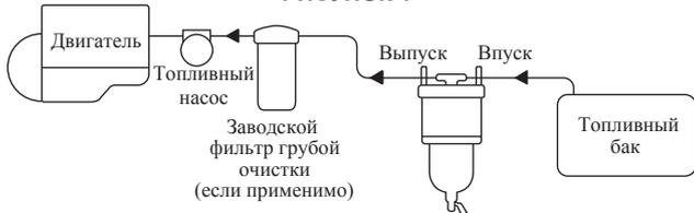
**ПРИМЕЧАНИЕ:** оставить 90-сантиметровый вертикальный зазор под устройством для обслуживания фильтрующего элемента и слива загрязнителей.
