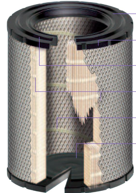
1 Рассчитанная на тяжелые условия эксплуатации прокладка, создающая радиальное уплотнение и сформованная из специального полиуретанового компаунда, не теряет своих свойств при предельных температурах, изменениях сопротивления и вибрациях.
